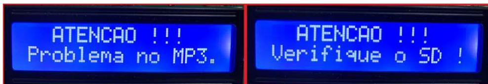
Fig.6 – Caso haja algum problema no módulo MP3 ou se o micro SD não estiver inserido, esta sequência de telas irá aparecer em seguida.
