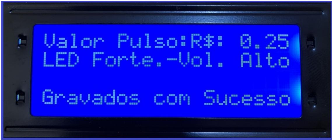
Fig.10-Tela confirmando sucesso na gravação. Solte os botões quando ela aparecer. Em alguns segundos o sistema voltará na Tela Principal validando as alterações.
